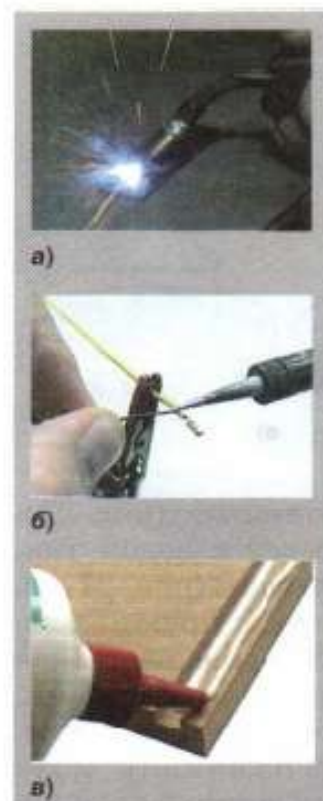
Различные виды соединения тел: а — сварка; б — пайка; в — склеивание
